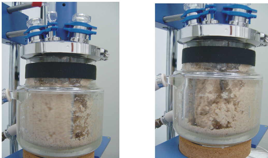
Figura 2. Movimento do farelo de mandioca dentro do tanque durante a agitação com o impelidor âncora.
