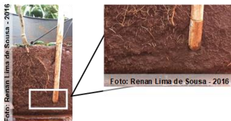
Figura 3. Profundidade da cápsula do extrator de solução no vaso
