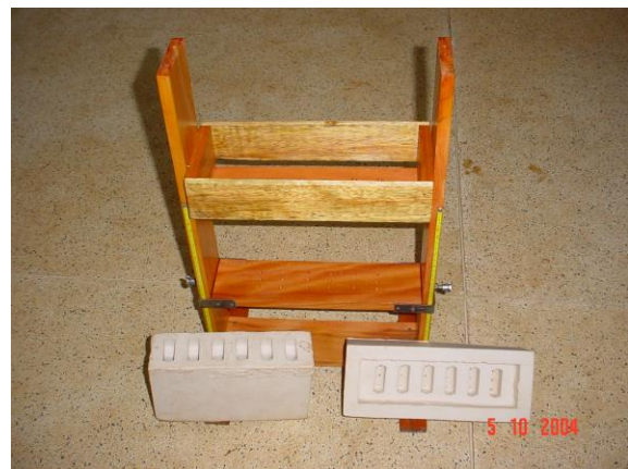
Figura 3. Gabaritos para montagem da sonda contínua de 3 hastes. A - Nylon; B - Silicone.
