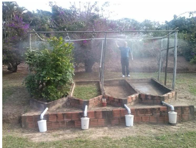
A cada evento chuvoso as precipitações, intensidade, interceptação, precipitação efetiva foram quantificadas e, o volume de escoamento superficial foi captado por quatro recipientes dispostos na secção inferior das parcelas conforme (Figura 1). Os volumes coletados foram quantificados em (mL) e posteriormente transformados em (mm).
