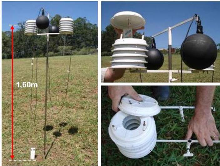
**Figura 5** - Vista geral do suporte com os equipamentos e detalhes do abrigo do mini datalogger.
