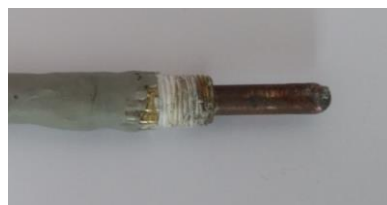
Figura 3 - Sonda contendo o sensor de temperatura LM35.
