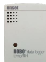
Figura 1 - Data logger HOBO U10-003 (dimensões: 45x60x20mm)
