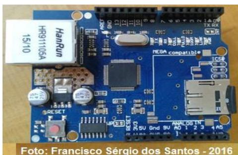
**Figura 4 - Módulo de rede WS5100 Arduino.**
