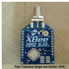
**Figura 8** - Módulo de transmissão de dados sem fio modelo XBee Pro S3B
