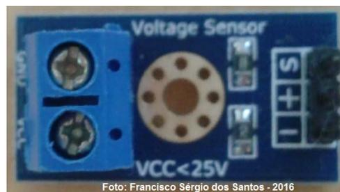
**Figura 7 - Sensor de Tensão**
