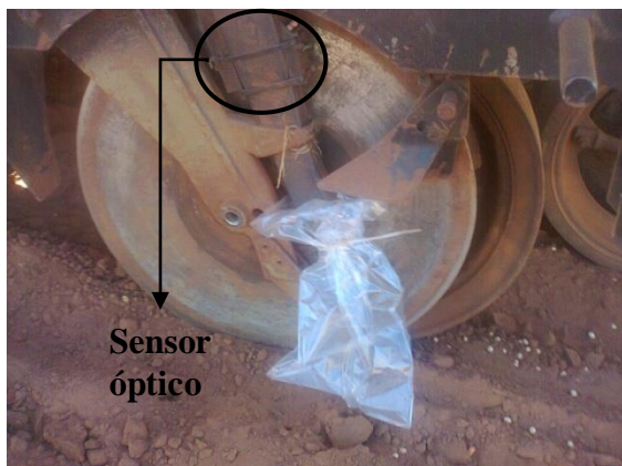
Figura 1. Coleta de sementes com embalagem plástica e sensor óptico.
