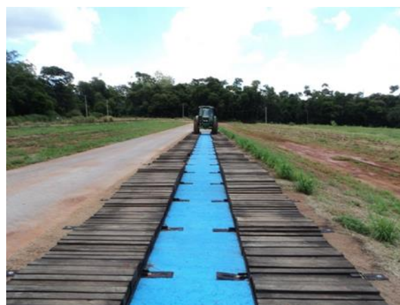
Figura 1 - Pista de vibração utilizada para ensaio. FCA/Botucatu, (2015).
