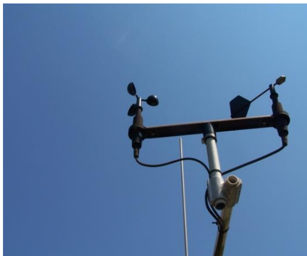
Figura 2 – Anemômetro, com o sensor de velocidade (modelo de três conchas) e o sensor de direção (leme). Fonte: autores (2009).
