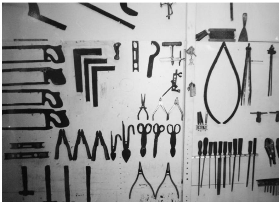
**Figura 4** - Aspecto da oficina mecânica após implantação dos três primeiros "S"
