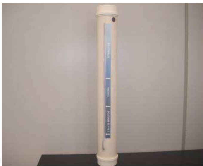
Figura 4. Detalhe do temporizador do conjunto de sequenciamento automático da irrigação.
