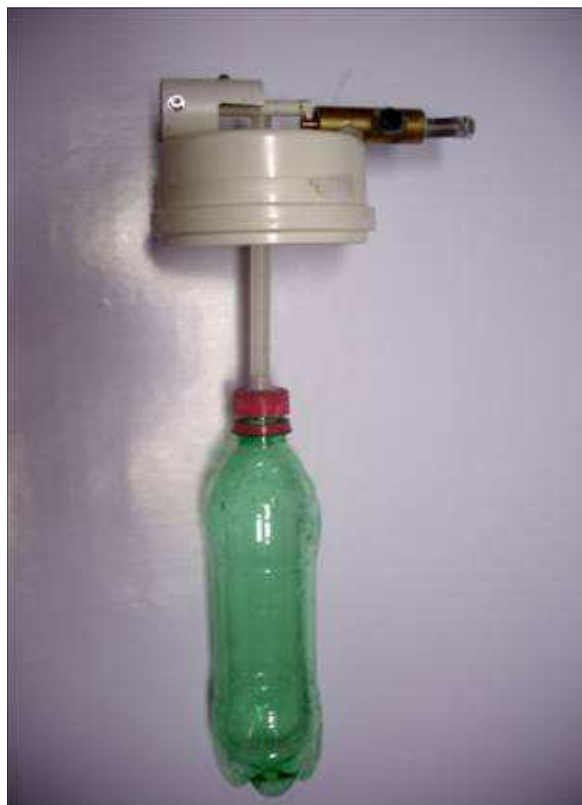
Figura 8. Detalhe da vista lateral do sistema de boia e gatilho do conjunto de sequenciamento automático da irrigação.
