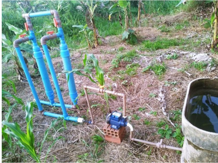
Figura 2. Imagem dos filtros de areia construídos em material de PVC rígido para avaliar a eficiência de remoção dos sólidos em suspensão presentes na água.
