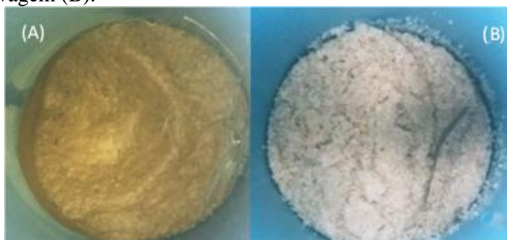
Figura 4. Camada de areia do elemento filtrante após a filtração da água (A) e depois da retrolavagem (B).
