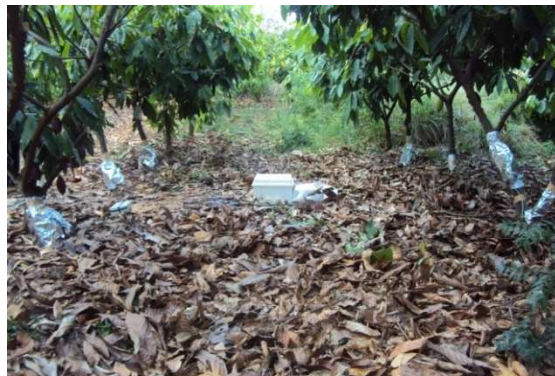
Figura 1. Esquema de instalação das sondas de dissipação térmica e vista do experimento.
