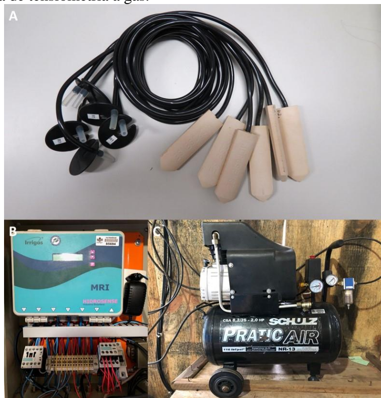
Figura 1. (A) Sensores Irrigás®, (B) controlador autônomo de irrigação baseado nos sensores Irrigás® e (C) moto-compressor de ar para fornecimento de ar comprimido ao sistema de tensiometria a gás.
