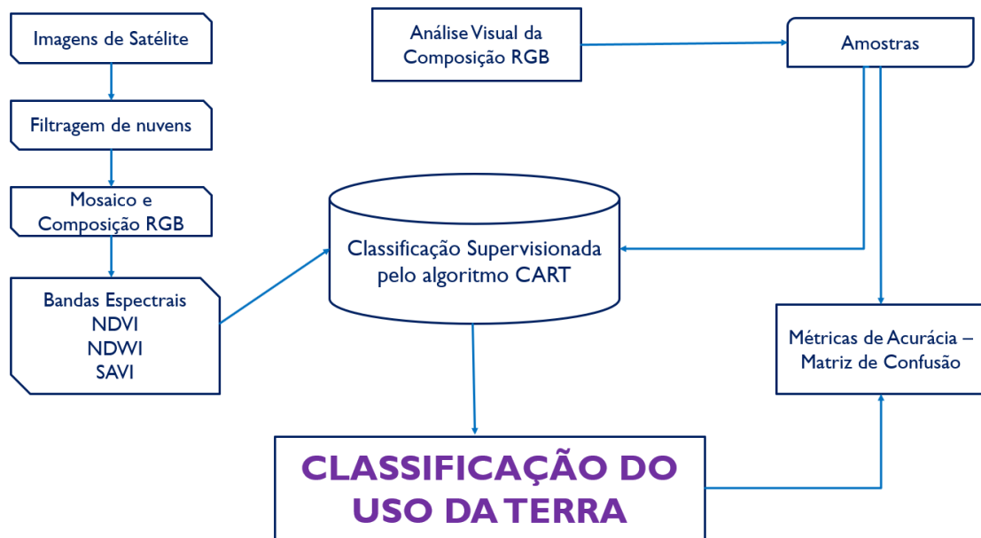
Figura 2. Fluxograma da classificação do uso da terra com ênfase na diferenciação entre área irrigada e sem irrigação.
