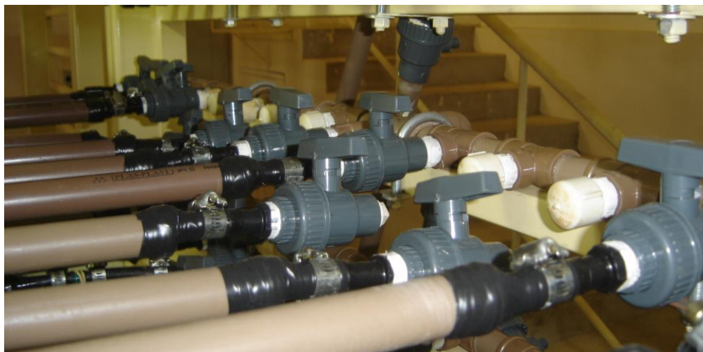
Figura 2. Linhas gotejadoras envolvidas por tubos de PVC 25 mm, no nível 3 da bancada de ensaios.
