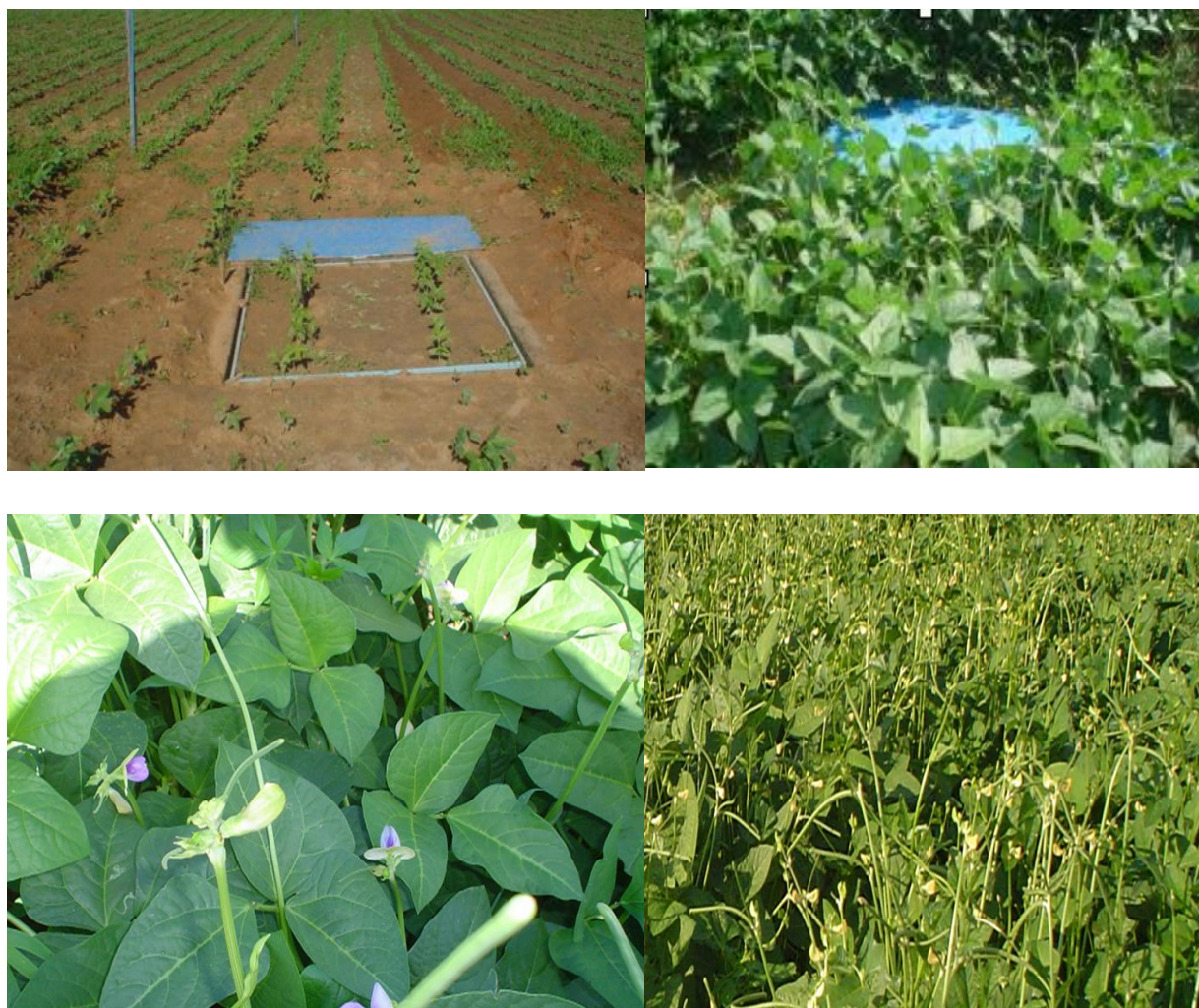
Figura 2. Lisímetro de pesagem com a cultura do feijão-caupi nos diferentes estádios de desenvolvimento. Alvorada do Gurguéia, PI, 2005.
