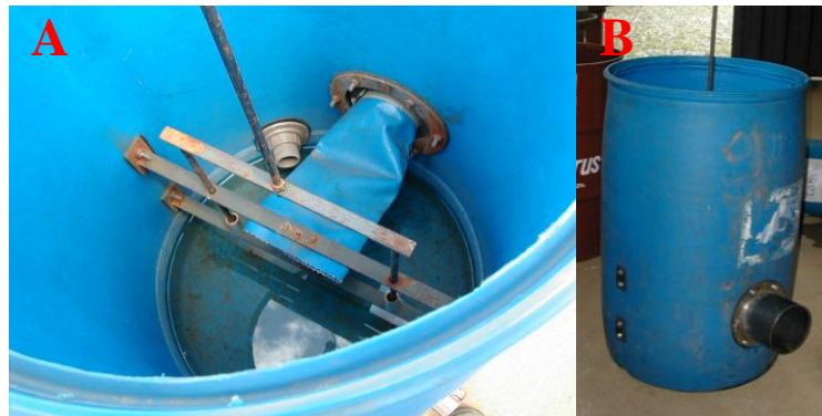
Figura 8. Protótipo 3, com detalhe do mecanismo de estrangulamento do mangote (A), e uma vista externa do aparato indicando a flange de entrada de água (B).
