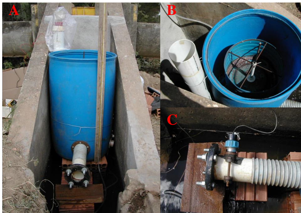
Figura 9. Protótipo 3 instalado em uma tomada d'água do projeto Gorutuba (A), com detalhes do flutuador e poço tranqüilizador para medição de nível (B) e sensor de vazão na saída do aparato (C). Nova Porteirinha, MG, 2005.
