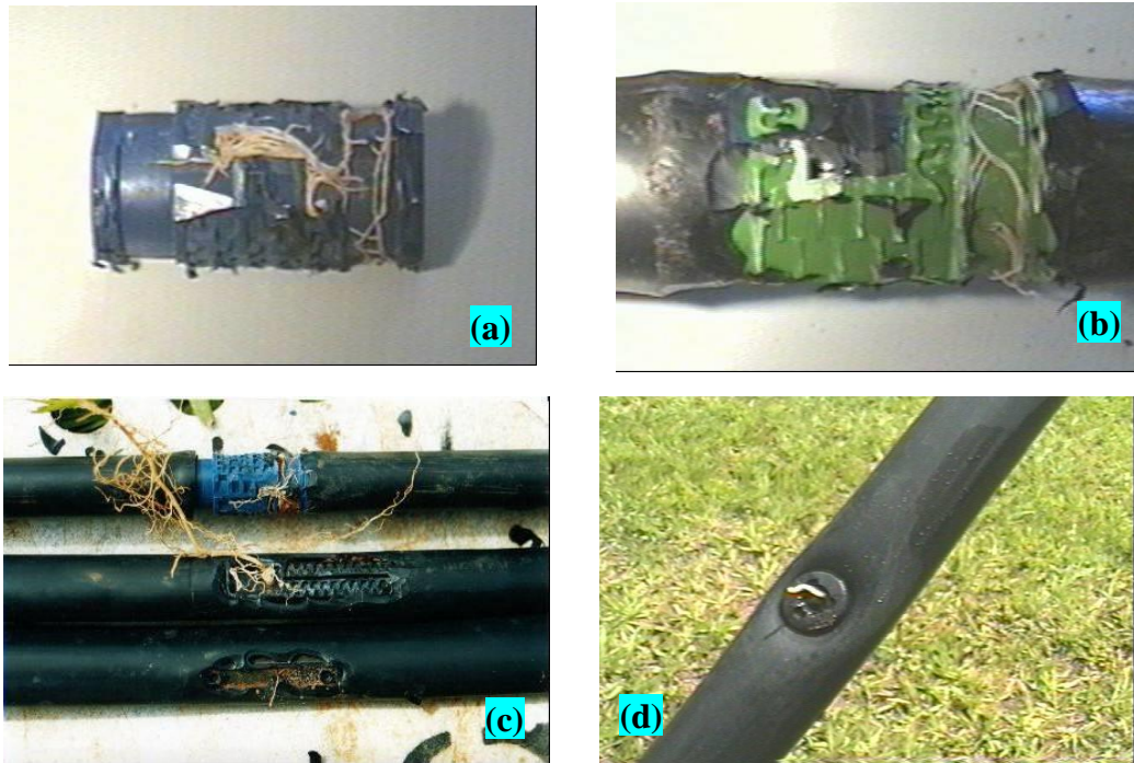
Figura 13. Intrusão radicular nos emissores: (a) emissor cilíndrico; (b) emissor cilíndrico; (c) emissores diversos; e (d) emissor botão.
