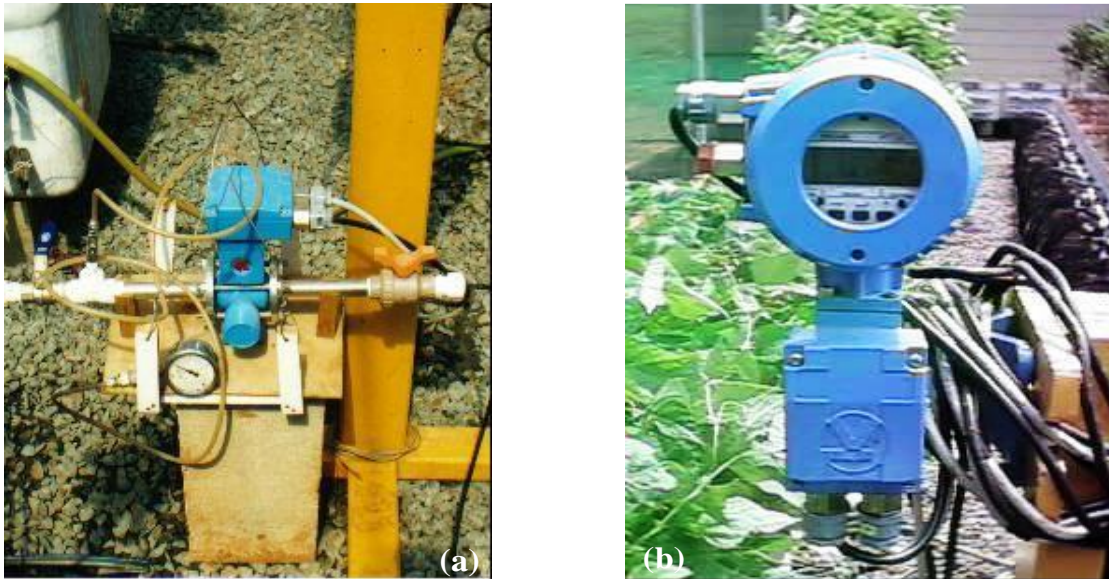
Figura 4 - Detalhes do medidor de vazão: (a) sensor magnético e (b) leitor digital.
