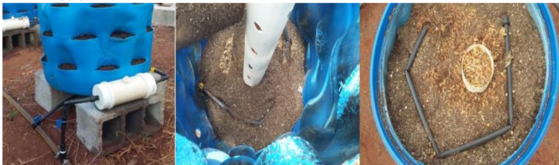
Figura 9. Injetor do biofertilizante em PVC e disposição da mangueira gotejadora no interior do barril.
