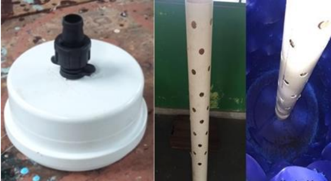
Figura 4. Detalhe do CAP, composteira e instalação no interior do barril.
