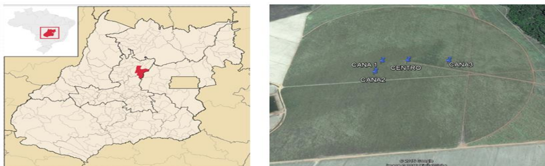
Figura 1. Local de coleta de dados para pesquisa - coordenadas geográficas 15^{\circ}15'57,75 S ; 48^{\circ}51'12,9 O , Goianésia, GO; Marcadores indicam o centro do pivô e os três pontos de instalação de sensores de monitoramento de umidade do solo e precipitação (chuva e irrigação).
