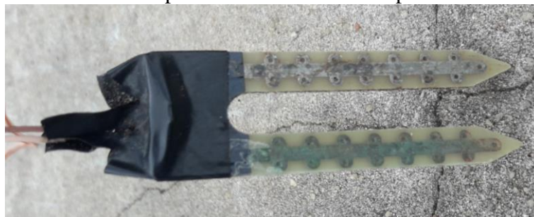
Figura 7. Sensor de umidade do solo após o uso durante o ciclo produtivo.
