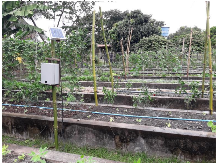
Figura 9. Processo de irrigação controlada pelo Arduino através dos sensores de umidade.
