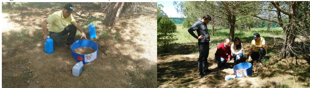
Figura 3. Infiltrômetro: infiltração da chuva, escoamento superficial e sedimentos do solo.
