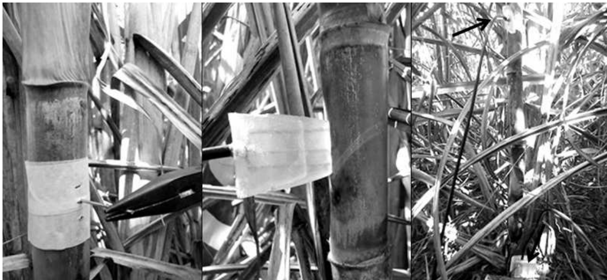
Figura 1. Inserção das sondas no colmo de cana-de açúcar e disposição final das sondas no solo e planta.
