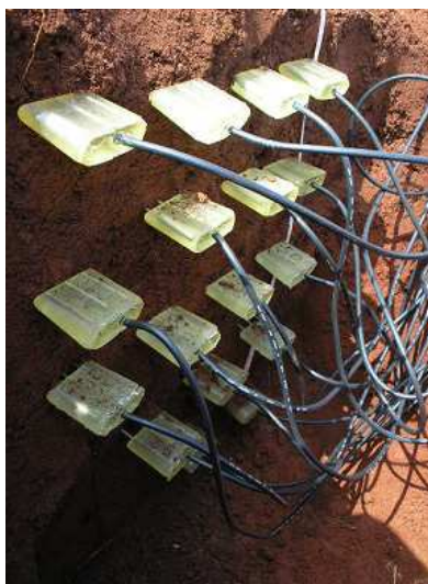
Figura 2. Disposição das sondas no perfil do solo para monitoramento da distribuição do potássio.
