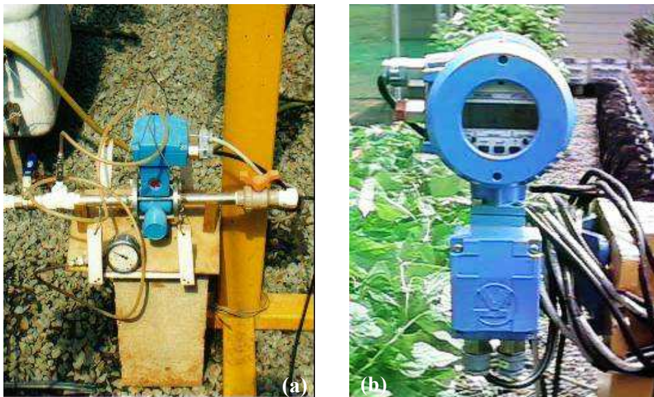
Figura 2. Detalhes do medidor de vazão: (a) sensor magnético e (b) leitor digital.
