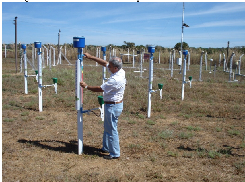
Figura 2. Vista dos Irrigâmetros instalados na área experimental.
