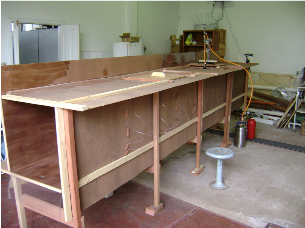
Figura 8 - Vista geral do túnel de vento depois da montagem no laboratório, incluindo o sistema de pulverização.
