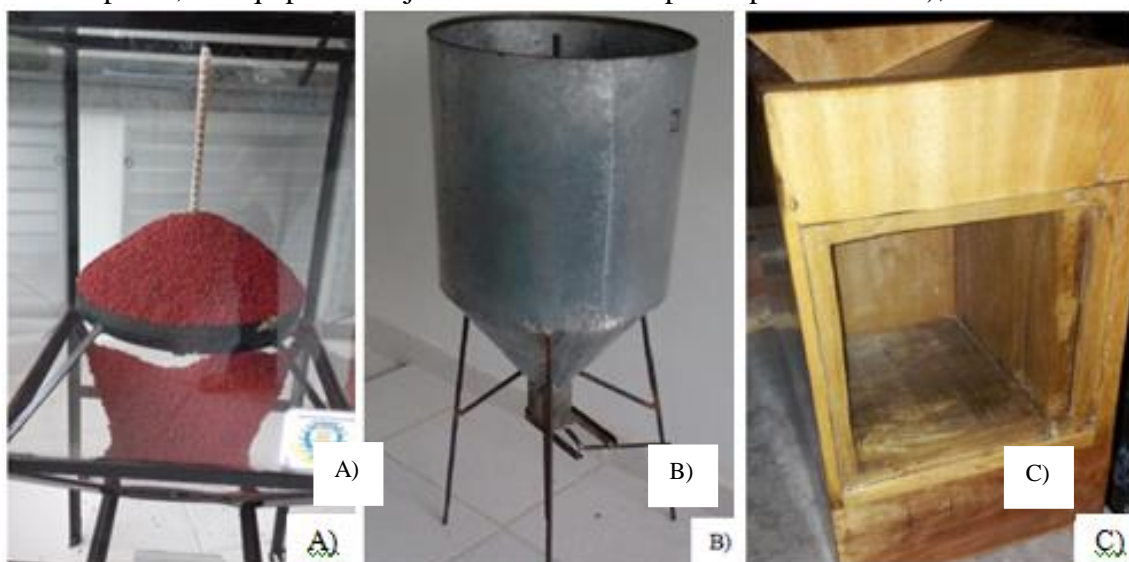
Figura 1. Equipamentos para medição do ângulo de repouso das sementes de urucum (A- protótipo adaptado, B- equipamento já estabelecido e C- protótipo alternativo), 2019.
