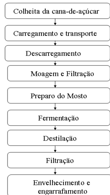
Figura 1 - Operações unitárias na produção de cachaça
